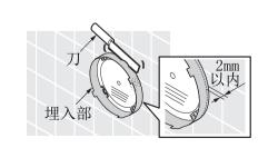
②完成墙面和埋入部的间隙, 打玻璃胶做防水处理,去除养 生盖、清洗盖
