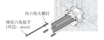
⑥再用L型六角扳手完全旋紧固定。
